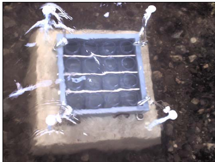
Abbildung 2 Foto einer eingebauten Schwebstofffalle vom Typ G
