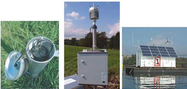
Abbildung 1: Beispiele für Ausführungen verschiedener Ausbaugrade von Messstationen: links – Ministation, Mitte – Kompaktstation, rechts – Modulstation in Containerform
